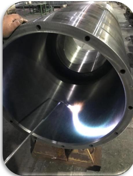
Aquecimento da peça para aplicação do revestimento de Metal patente
